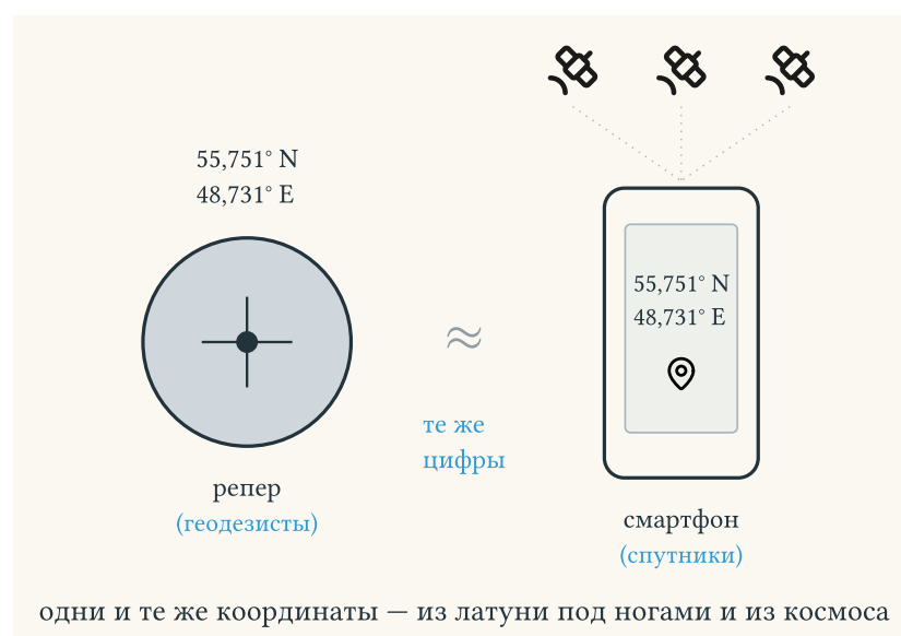
Рис. 1. Одни и те же координаты приходят двумя путями: выбиты на латунном репере геодезистами и появляются на смартфоне от спутников.
